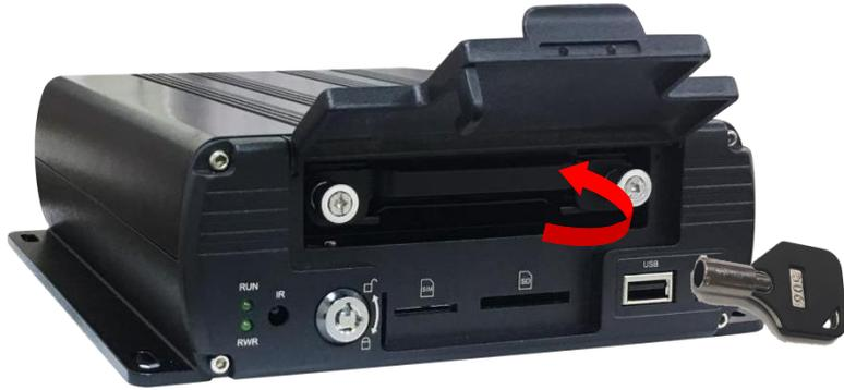
1. 使用鑰匙解鎖後，取出硬碟抽取盤。
